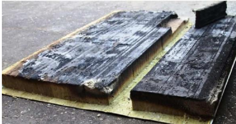
IMPREGNIRANA KAMENA VUNA POSLE POŽARA
