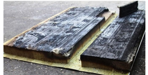
Na kamenoj vuni gori hidrofobni premaz
